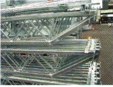
Kuumasinkittyjä kattoristikkoita. Rajoitettu piipitoisuus.
